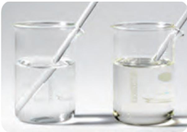
Abb. 5: Illustration der Wirkung von unterschiedlichen und gleichen Lichtbrechungsindizes: Glasstab in Wasser (links) und in einer Monomermischung mit abgestimmtem Lichtbrechungsindex (rechts).
