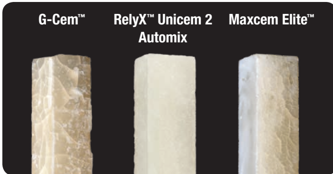
Abb. 18: Ergebnisse von Belastungstests bei selbstadhäsiven Composite-Zementen. Alle Prüfmuster waren selbstgehärtet und durchliefen 10 000 Zyklen einer thermischen Wechselbelastung. Quelle: Interne Daten von 3M ESPE
